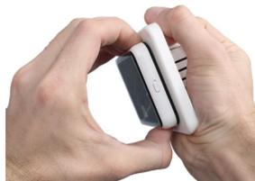
2) Das Thermostat ist mit zwei Clips versehen, die die Gehäuseteile zusammenhalten. Sie können das äußere Gehäuse entfernen, indem Sie es oben und unten mittig eindrücken und mit Kraft abziehen. Unterstützen Sie diesen Vorgang, indem Sie das Thermostat von der anderen Seite in die entgegengesetzte Richtung ziehen.
