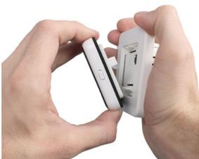
4) Um die beiden Teile wieder zusammenzusetzen, verbinden Sie den herausstehenden Konnektor vorsichtig mit der dafür vorgesehenen Buchse auf der Rückseite des zuvor entfernten Gehäuses. Achten Sie dabei darauf, dass die Kontakte gleichmäßig und nicht unter einem Winkel eingesteckt werden, da sie sonst verbogen und beschädigt werden könnten.
