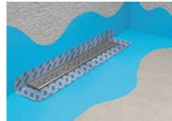
5. Bringen Sie nun die mitgelieferte Dichtmanschette sowie ggf. weitere Dichtmaterialien wie Dichtband, Dichtecken oder Rohrmanschetten falls benötigt, auf die frisch aufgetragene Flüssigfolie auf und lassen diese erste Schicht ca. eine Stunde lang trocknen.
