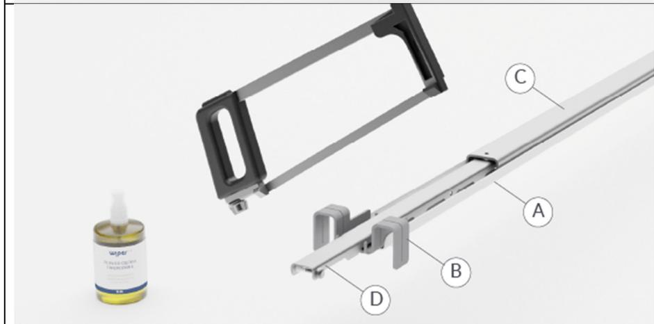
2. Kürzen Sie nun das Designrost auf beiden Seiten jeweils um den gleichen Anteil, wie zuvor den Duschrinnenkörper (Achtung: der einfache Zuschnitt des Designrosts auf die zuvor bestimmte Gesamtlänge ist falsch! Es muss symmetrisch um den gleichen Faktor gekürzt werden wie der Ablaufkörper). Nach Zuschnitt sollte das Designrost insgesamt 28 mm (= 14 mm pro Seite) kürzer sein, wie der bereits zugeschnittene Rinnenkörper.
