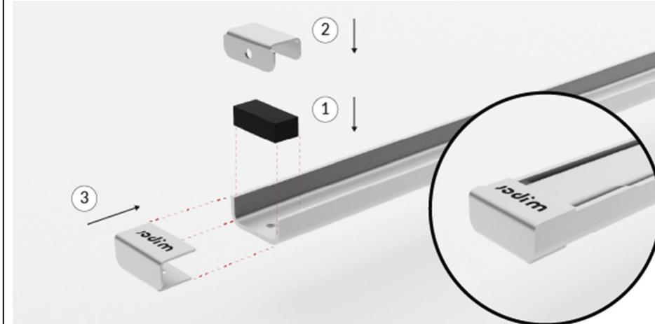
4. Setzen Sie zum Schluss die beiden Metallkappen/Endstücke auf die geschliffenen Enden.
