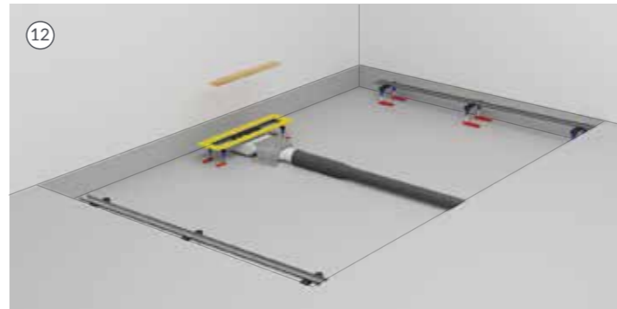
12. Die Pappkartonabdeckung zum Schutz des Inneren der Rinnenbasis gegen Zementmörtel und andere Verschmutzungen wieder anbringen. Die Siphonabdeckung/Gitter zur Verstärkung des Siphons montieren.
