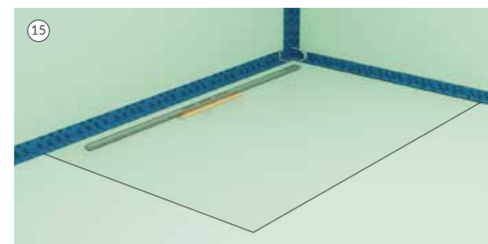
15. Isolieren Sie den Duschbereich vollständig entsprechend des gewählten Abdichtverfahrens, z.B. mit dem empfohlenen WIPER Dichtset. Unmittelbar nach dem Aufbringen der Flüssigdichtfolie auf der gesamten Oberfläche, wird der Rinnenkörper in seine Zielposition gebracht und auf die Rinnenbasis aufgesetzt.
