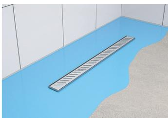
4. Tragen Sie als erstes die Grundierlösung (Primer) auf den getrockneten Estrichbereich auf und lassen diesen ebenfalls trocknen. Tragen Sie danach die erste dünne Schicht der Flüssigdichtfolie auf die Primerschicht auf (z.B. das Wiper® Dichtungssset, zusätzlich bestellbar). Beachten Sie hierbei, dass Sie noch Platz für eine weitere Schicht der Folie sowie für die Dichtmanschette benötigen.
