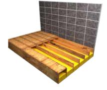
Verwenden Sie eine Stichsäge, um die zuvor markierte Fläche ausschneiden. Entfernen Sie die Bodenplatten/Holzdielen, um die Bodenträger freizugeben. Standardmäßig sollten die Dielen 20 mm dick sein - ein 20 mm starkes Duschelement wäre hier also die optimale Wahl, um einen barrierefreien Duschbereich zu erzielen. Sollten der Boden dicker als 20 mm sein, so sollten Sie auch ein entsprechend stärkeres Duschelement einbauen.
