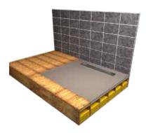
Kleben Sie das Duschelement nun in die vorgesehene Fläche ein. Verbinden Sie anschließend den Siphon mit der Duschrinne von oben – eine separate Einbauanleitung finden Sie hier: www.modernedusche.de/montageanleitung-siphons. Überprüfen Sie Halt und Position aller Elemente, sowie die Bodenbündigkeit zwischen der Duschplatte und dem Rest des Duschraumes.
