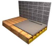
Platzieren Sie das Duschelement auf der vorgesehenen Duschraumfläche, fixieren Sie es und zeichnen es auf. Achten Sie dabei darauf, dass das Element in den Ecken festsitzt. Markieren Sie auch die Ablaufrichtung und Position der Duschrinne
